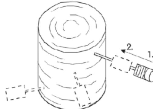
Anwenden Sie immer die Skala 1 mit Melenze 1 (W-251) und die Skala 2 mit Lanze 2 (W-252), unabhängig von Ballentyp.
