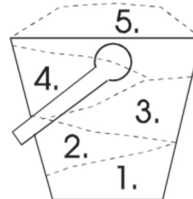
Schichtweise (Bild oben), ca 5 Schichten und komprimieren Sie das Heu mit Händedruck. Normalerweise ist eine Handvoll Heu, von einem kleinen Gebiet genommen, genug für eine Schichte. Drücken Sie die Parabolsonde Nr 3 in die Probe, fest gegen die Oberfläche mit einem Druck von ca 200N (ungefähr 20 kg), drücken Sie Taste P (es ist wichtig da unter der ganzen Mezeit der Druck auf das Heu gleich ist) und nach ca 15 Sek. erhalten Sie das Resultat..
